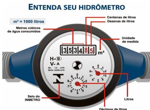
Fig. 02 – leitura do hidrômetro analógico
